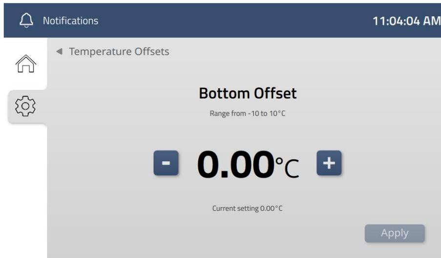
Figura 14.10 Offset di temperatura della base
